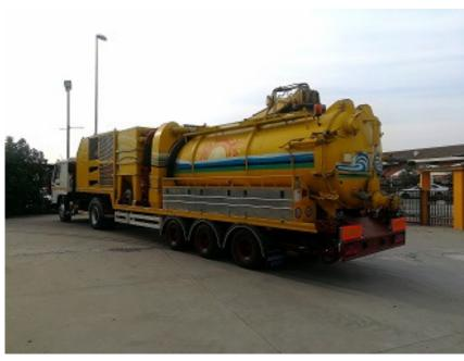
CISTERNA RIBALTABILE IN ACCIAIO AL CARBONIO DA 16.000 litri ca. CON APERTURA IDRAULICA DEL FONDO - CHIUSURA DEL FONDO A VOLANTINI
