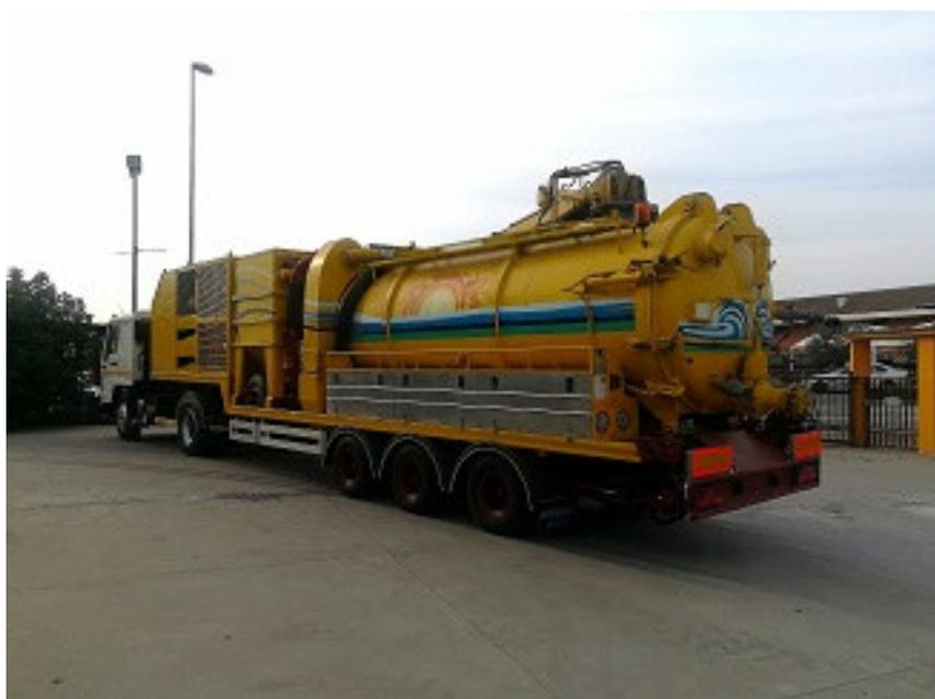
CISTERNA RIBALTABILE IN ACCIAIO AL CARBONIO DA 16.000 litri ca. CON APERTURA IDRAULICA DEL FONDO - CHIUSURA DEL FONDO A VOLANTINI
